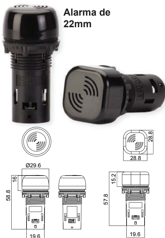
Lampara piloto con alarma 90dB
